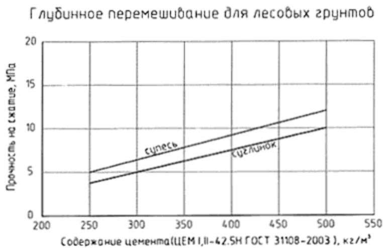
Рисунок Ф.3 - Зависимость прочности грунтоцемента от содержания цемента в 1 м ГЦЭ
